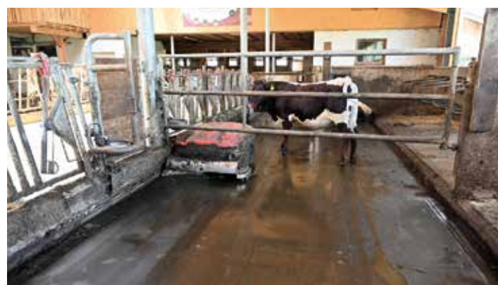
DER LELY DISCOVERY COLLECTOR bringt baulich viele Vorteile. Der Reinigungsroboter braucht nur eine planbefestigte Lauffläche in einer Ebene.
