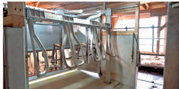
DER DREIER-SIDE-BY-SIDE-MELKSTAND war platztechnisch die einfachste Lösung, die Melktechnik wurde von der bestehenden Rohmelkanlage übernommen. Die Kosten sind damit im Rahmen geblieben, der Arbeitskomfort ist deutlich gestiegen.
