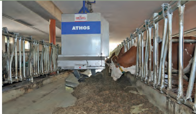
DER ATHOS-FÜTTERUNGSROBOTER DER FIRMA HETWIN wird über ein Abwurfloch beschickt. Der Austragungswagen beinhaltet 1,5 m³. Der Futtertisch hat eine Breite von 2,8 Metern. Die Milchkühe werden 6 x am Tag gefüttert und 6 x angeschoben. IN DER ALTEN TENNE befindet sich der Vormischer mit 11 m³, der mit dem Kran befüllt wird.
