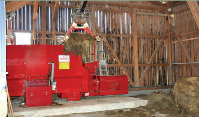
DER ATHOS-FÜTTERUNGSROBOTER DER FIRMA HETWIN wird über ein Abwurfloch beschickt. Der Austragungswagen beinhaltet 1,5 m³. Der Futtertisch hat eine Breite von 2,8 Metern. Die Milchkühe werden 6 x am Tag gefüttert und 6 x angeschoben. IN DER ALTEN TENNE befindet sich der Vormischer mit 11 m³, der mit dem Kran befüllt wird.
