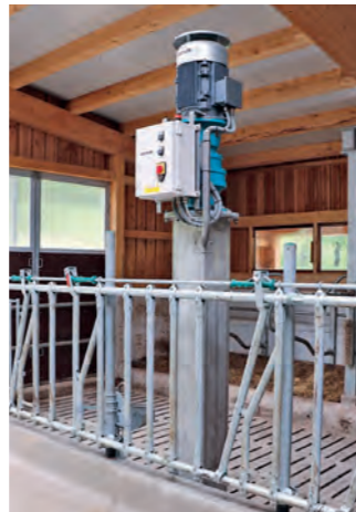
DAS AXIALRÜHRWERK überzeugt in der Funktion im Zusammenspiel mit der eckigen Güllegrube besonders.
