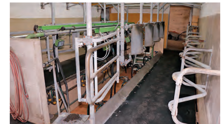
DER MELKSTAND wurde gebraucht bezogen und beidseitig um einen Stand verkürzt.
