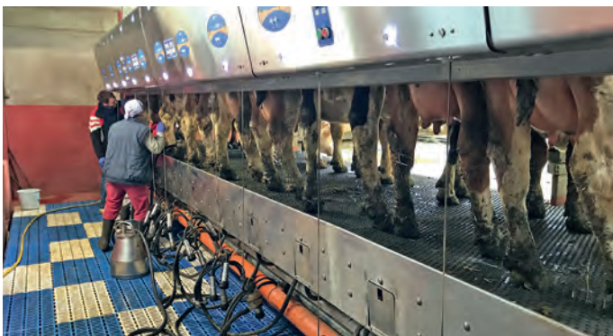
DER 10ER-SIDE-BY-SIDE-MELKSTAND in Nirost ist eine platzsparende Lösung mit Schnellaustrieb, zudem optisch ansprechend im Design. Der Kunststoffspaltenboden dient für den weichen Stand des Melkers.
