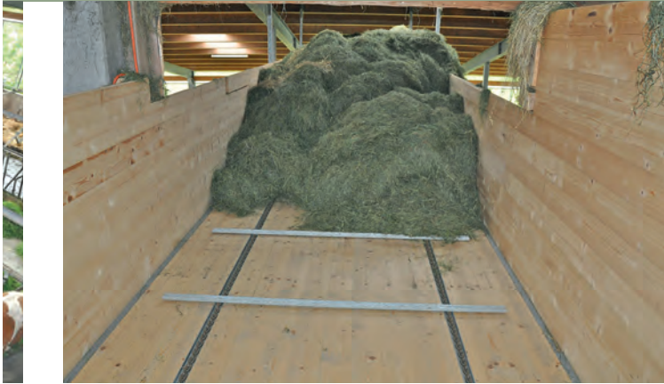
EIN FÖRDERBAND transportiert mittels Funkfernbedienung das Heu von der Heubergehalle unmittelbar auf den Futtertisch.
