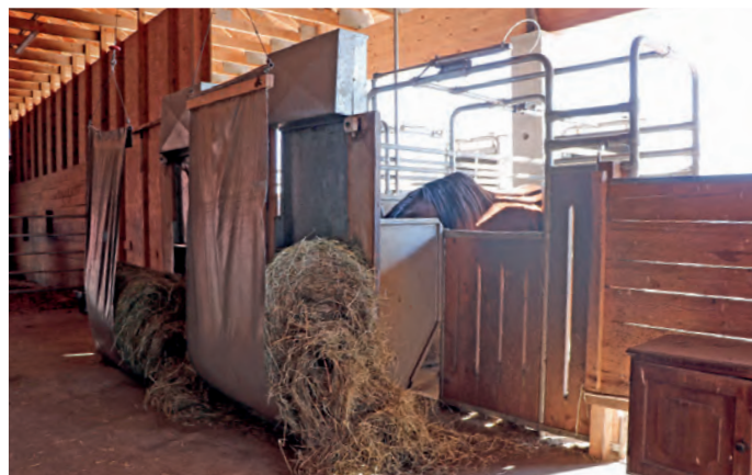
BEI DEN BEIDEN RAUFUTTERSTATIONEN wird jeweils ein Heuballen auf eine Plane platziert. Mit einer Winde wird das Planenende hochgezogen und somit der Ballen immer wieder zum Fressgitter gedrückt.
