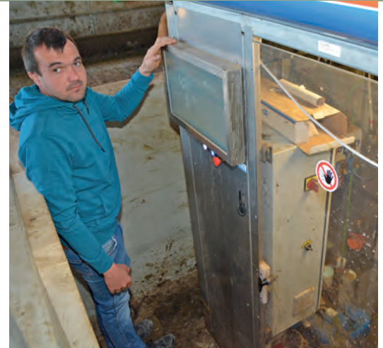
AM MELKROBOTER kann individuell für jede Kuh die Kraftfutterzuteilung gesteuert werden.
