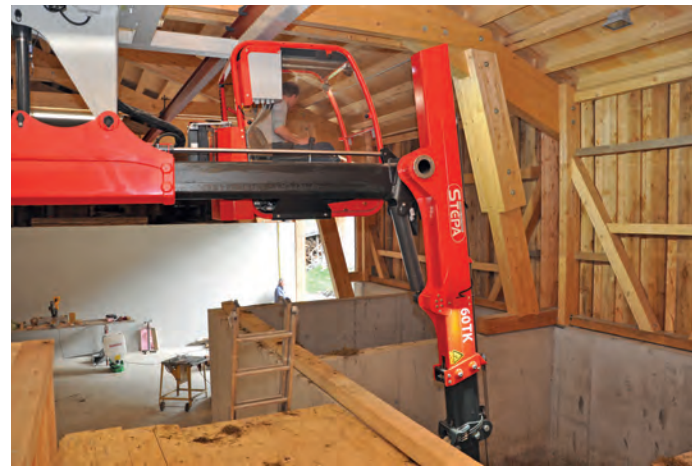
DER KNICKARM ermöglicht eine problemlose, übersichtliche Entnahme aus dem sechs Meter tiefen Hochsilo. Fotos: Mooslechner
