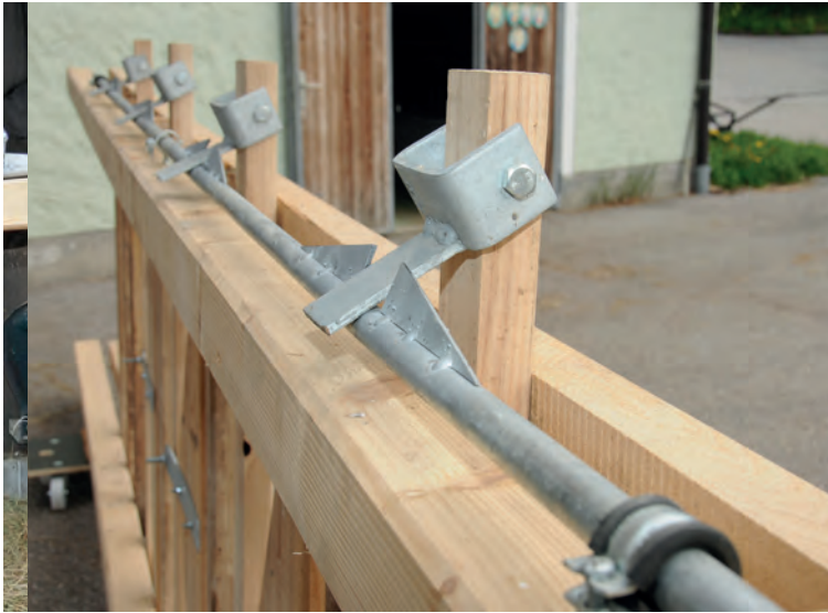
DIE VERRIEGELUNG funktioniert wie bei anderen Selbstfangfressgittern über ein verdrehbares Metallrohr. Die Baupläne werden gerne weitergegeben.
