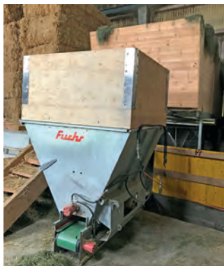
MIT DEM EINSTREUGERÄT werden die Liegeboxen befüllt. Die Säulen sind auf die Barrenmauer aufgesetzt um keine schmutzigen Ecken zu haben.
