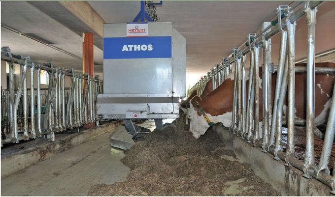
**DER ATHOS-FÜTTERINGSROBOTER DER FIRMA HETWIN** wird über ein Abwurfloch beschickt. Der Austragungswagen beinhaltet 1,5 m<sup>3</sup>. Der Futtertisch hat eine Breite von 2,8 Metern. Die Milchkühe werden 6 x am Tag gefüttert und 6 x angeschoben. **IN DER ALTEN TENNE** befindet sich der Vormischer mit 11 m<sup>3</sup>, der mit dem Kran befüllt wird.
