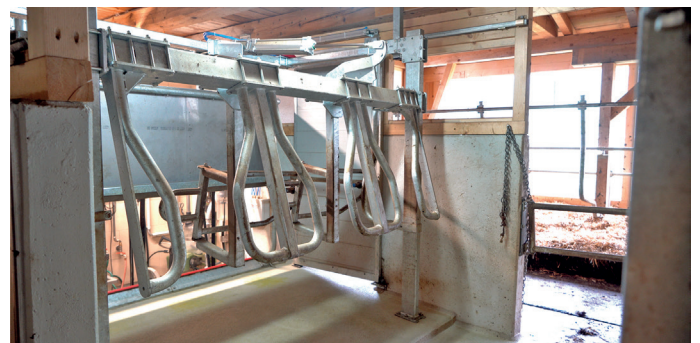
DER DREIER-SIDE-BY-SIDE-MELKSTAND war platztechnisch die einfachste Lösung, die Melktechnik wurde von der bestehenden Rohrmelkanlage übernommen. Die Kosten sind damit im Rahmen geblieben, der Arbeitskomfort ist deutlich gestiegen.
